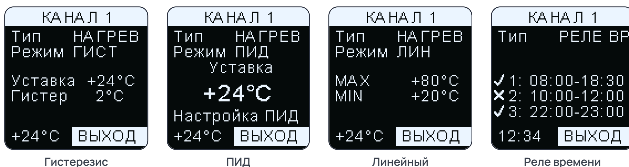
Рисунок 9 — Экраны настройки канала для разных режимов
